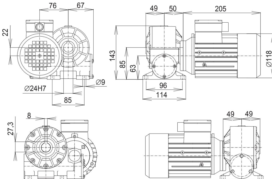
**Описание:** Компактный редуктор со сдвоенной червячной передачей в одном шкафу с жесткими базами и полым выходным валом.
